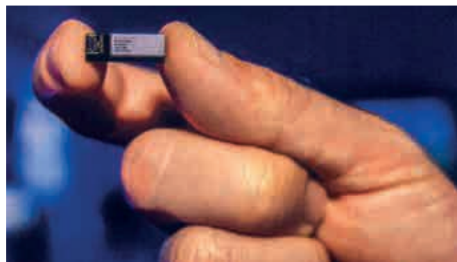
Array-Modul mit vier Antennen für ein 5G-Smartphone. Mobiltelefone werden vier solcher Module haben, also insgesamt 16 Antennen.
